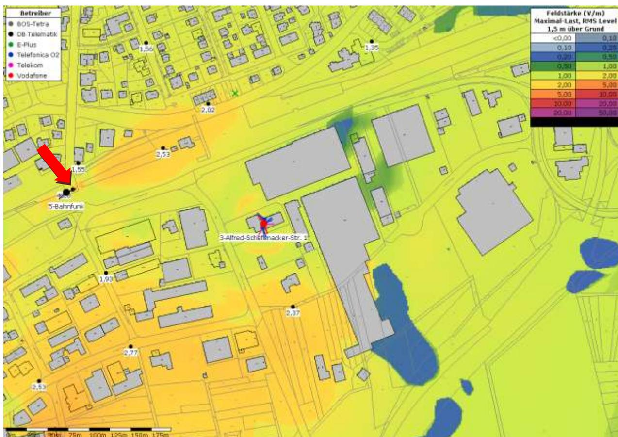
Abb. 11: Immissionsverteilung im Umfeld des Standorts Alfred-Schefenacker-Str bei Vollausbau der Mobilfunkstandorte nach der aktuellen Standortbescheinigung (Höchster Wert in 1,5 m Höhe tritt im Bereich des Bahnhofs durch Bahnfunkmast auf mit grünen Kreis und Pfeil markiert)
