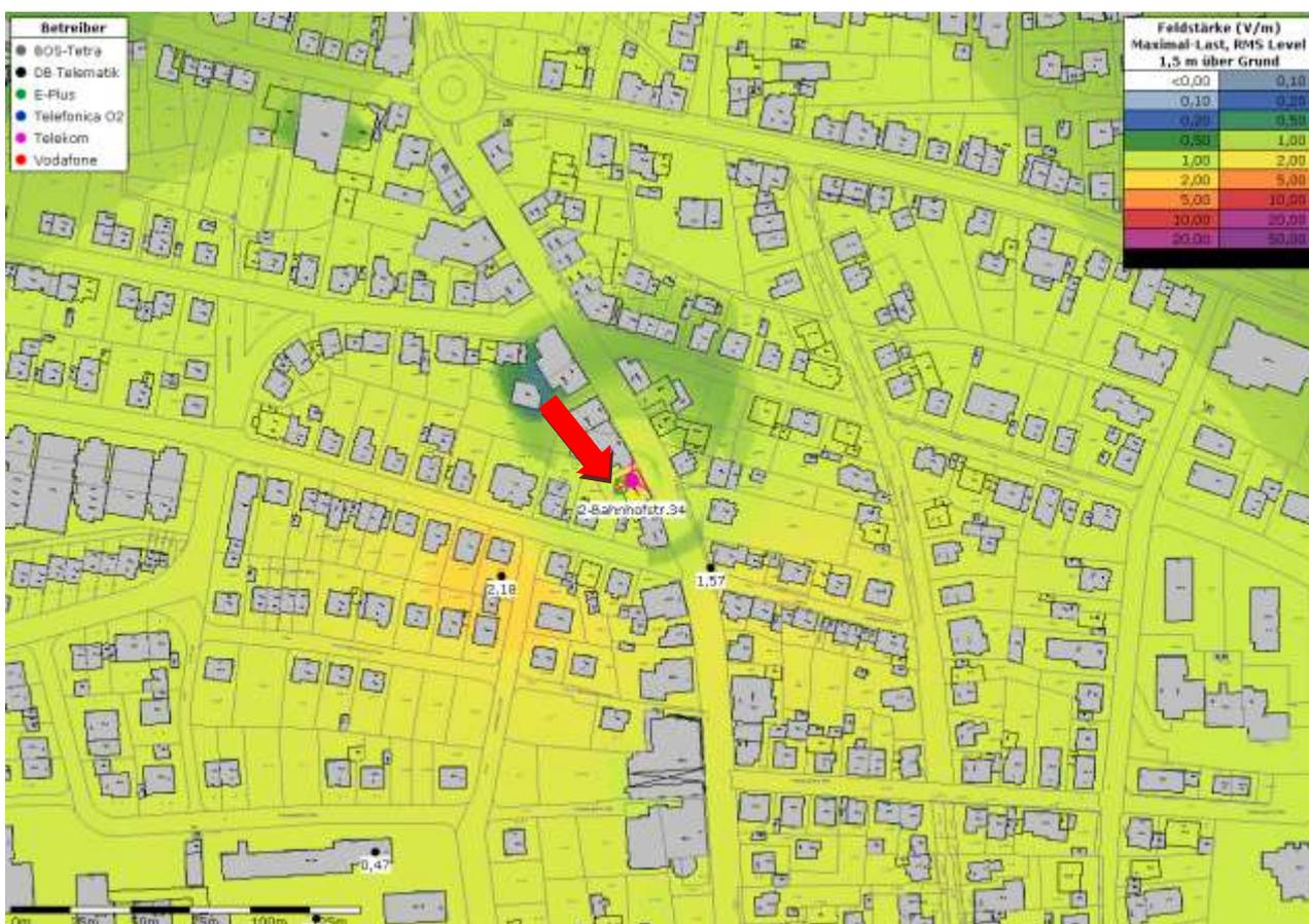
Abb. 8: Immissionsverteilung im Umfeld des Standorts Bahnhofstraße bei Vollausbau der Mobilfunkstandorte nach der aktuellen Standortbescheinigung (Höchster Wert in 1,5 m Höhe mit grünen Kreis und Pfeil markiert)
