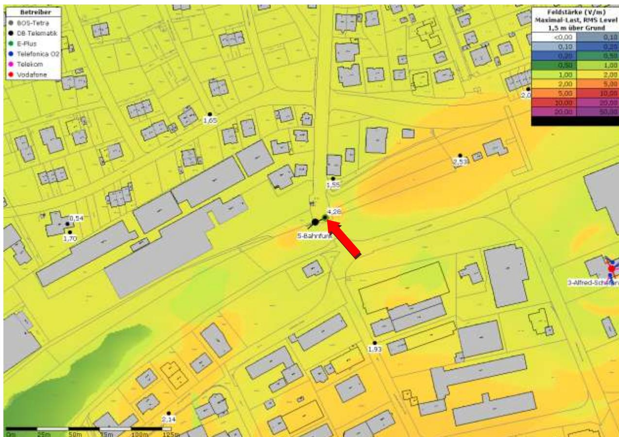
Abb. 17: Immissionsverteilung im Umfeld des Standorts Funkmast Bahn bei Vollausbau der Mobilfunkstandorte nach der aktuellen Standortbescheinigung (Höchster Wert in 1,5 m Höhe mit grünen Kreis und Pfeil markiert)
